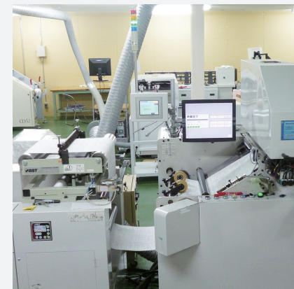
浮田工業 SJ-500 UVインクジェットプリンター。UVインク使用により、用紙をほぼ選ばず印字ができ、印字濃度も5段階で調整可能。用紙に合ったインク量を選べる。
