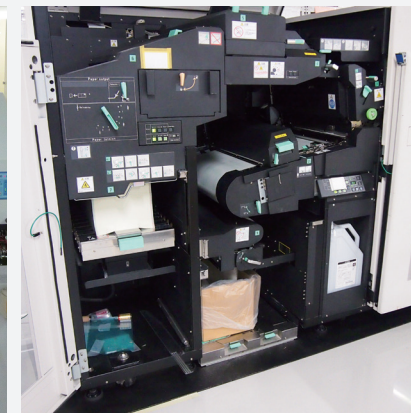
ゼロックス 650J 非接触のフラッシュ定着方式を採用したトナー印刷により、高速かつ幅広い種類の用紙にプリントが可能。
