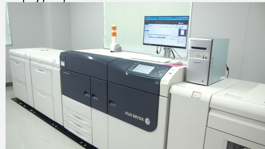
オンデマンド印刷機 V3100 両面フルカラーのオンデマンドプリンター。小ロットのフルカラー可変情報の印字が可能。
