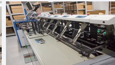
BPS インセルコ封入封緘機（オンライン封緘機） 定型封筒用封入封緘機でブックイング機（GBS-1650）を設置することで納付書などの抜き機能も可能。
