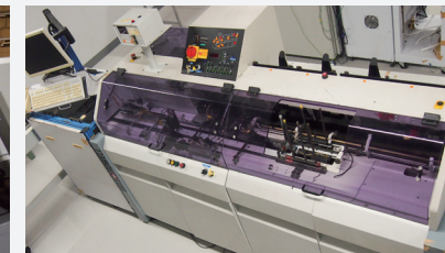
ビテッセ封入封緘機（オフライン封緘機） 定型封筒用封入封緘機の高速インサーター
